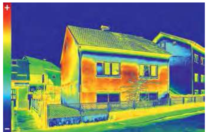
Relevé thermographique d'une maison
