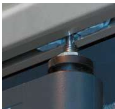
Galet emprisonné sur rail anti-déraillement
