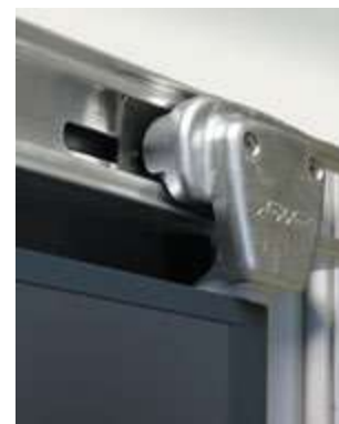
Galet emprisonné sur rail anti-déraillement
